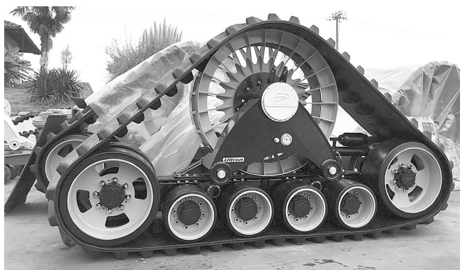
Рис. 2. Треугольный гусеничный модуль [12]
