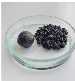
Рис. 1. Пресс-масса на основе древесной коры после отлива без приложения давления
