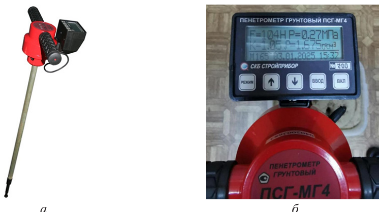
Рис. 3. Пенетрометр: а – общий вид; б – показания на мониторе
