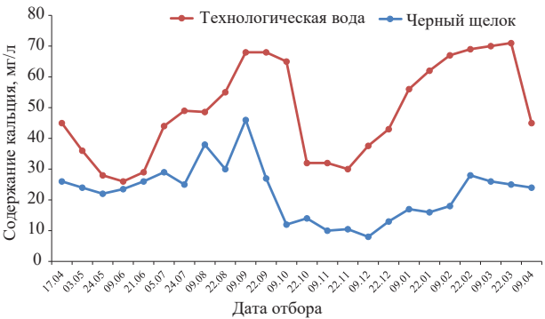
Рис. 4. Изменение концентрации кальция в производственной воде и черном щелоке в зависимости от времени года Fig. 4. Changes in calcium concentration in process water and black liquor depending on the season
