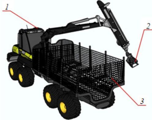
Уменьшение длины древесного сырья достигается применением механизма с гильотинным ножом (рис. 3), установленным на манипулятор форвардера. Разделение сучьев и веток осуществляется грейфером, при необходимости они разрезаются встроенными ножами. В отличие от других типов режущих инструментов (цепная, дисковая пила), использование гильотинного ножа оригинальной формы для разрезания данных порубочных остатков энергетически более эффективно.
