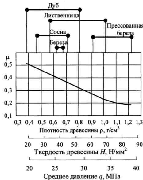
Рис. 1. Изменение коэффициента трения скольжения  $\mu$  на передней поверхности лезвия от плотности  $\rho$  и твердости  $H$  древесины и среднего давления  $q$
