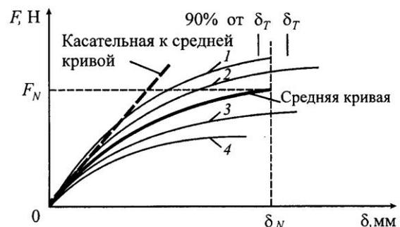
направлениях, из производственного материала или из лабораторных отливок, строят типичную среднюю кривую «нагрузка – удлинение», по которой рассчитывают параметры материала.
