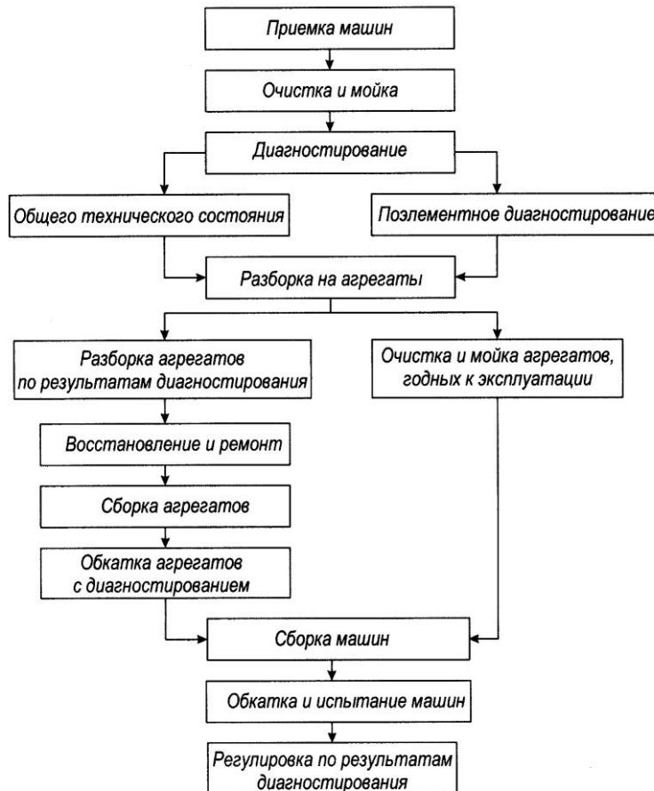
Рис. 1. Блок-схема технологического процесса капитального ремонта
