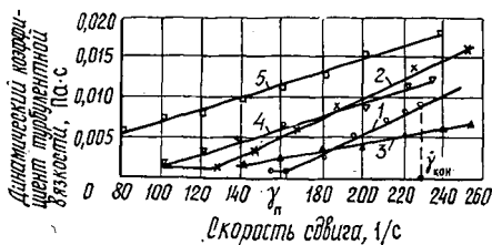
Рис. 2. Зависимость динамического коэффициента турбулентной вязкости от скорости сдвига для: 1 — бумажной массы концентрацией 6 г/л; 2 — волокнистой суспензии беленой сульфитной целлюлозы концентрацией 5 г/л; 3 — волокнисто-порошковой суспензии концентрацией 7... 11 г/л; 4 — воды (рифленный внутренний цилиндр); 5 — воды (шероховатые измерительные поверхности)
