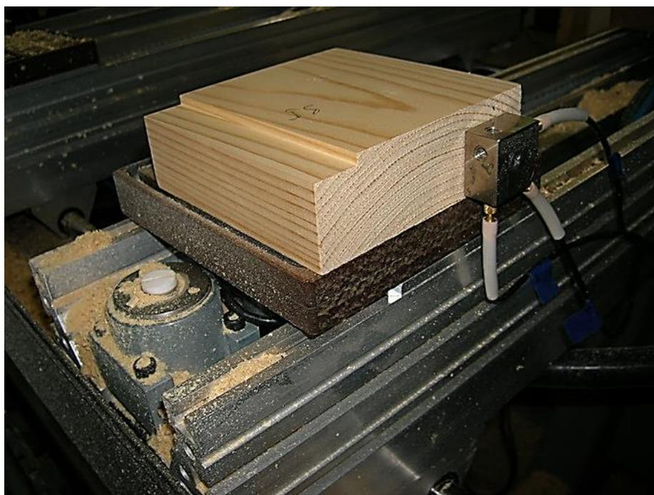
Рис. 2. Схема установки датчика на заготовке
