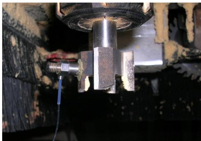
Рис. 4. Схема установки датчика на фрезу
