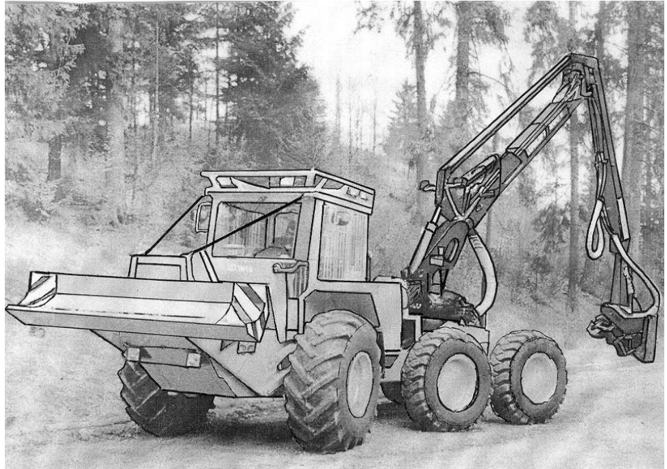
Рис. 2. Многооперационный аппарат LKT 120H (Республика Словакия, Трстена)
