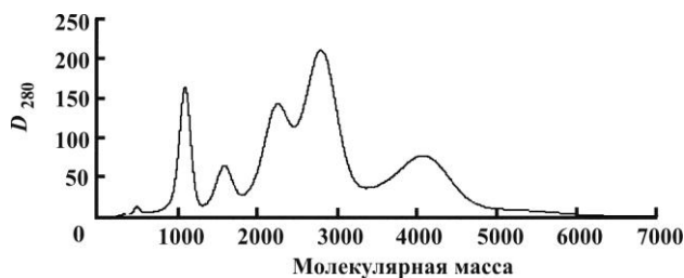
Рис. 2. Молекулярно-мас-совое распределение продуктов ферментативного окисления гваякола в водной среде (время реакции 30 с; рН 6,0; C_{\text{гва}} = 1 \cdot 10^{-3} М; C_{\text{H}_2\text{O}_2} = 100 \cdot 10^{-6} М; C_{\text{HRP}} = 1 ед./мл)
