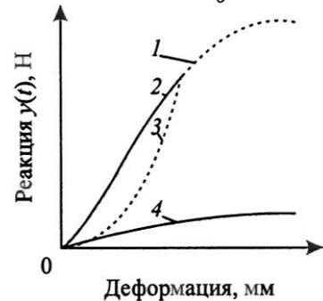
Уравнение (2) точно описывает поведение образца при непрерывном деформировании, вплоть до момента хрупкого разрушения, которому соответствуют максимальные деформация  $x_{\max}$  и реакция  $y_{\max}$ . При этом уравнение (2) описывает реакцию при деформациях, больших  $x_{\max}$ , которые наблюдаются только при ползучести нагруженного образца.
