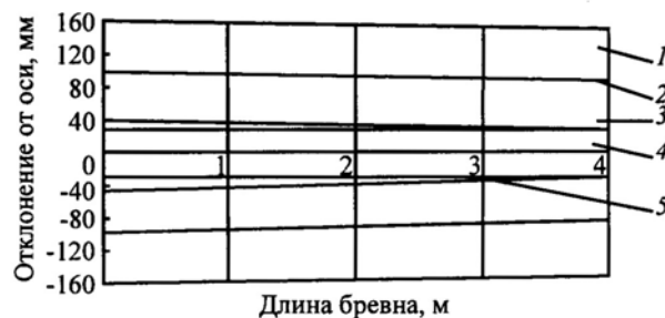
Рис. 7. Продольный разрез комлевого бревна: 1 – заболонь; 2 – граница «заболонь–ядро»; 3 – ядро; 4 – зона непрерывного роста сердцевинной древесины; 5 – зона роста ствола до 4 м
