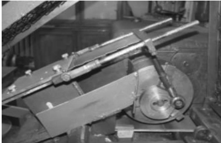
Рис. 1. Экспериментальная установка для исследования ленточных пил на усталостную прочность при изгибе
