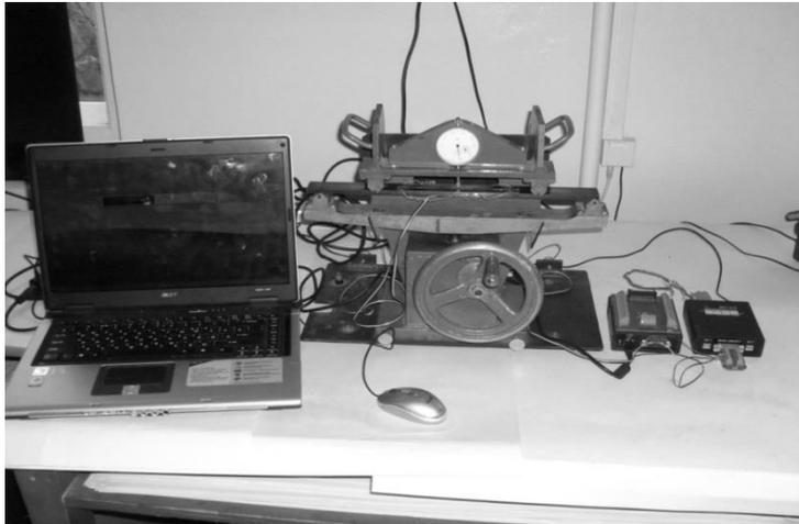
Рис. 2. Измерительный комплекс для тарировки тензодатчиков
