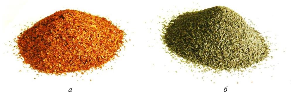
Рис. 1. Кора сосны обыкновенной: *a* – до модификации; *б* – после модификации
