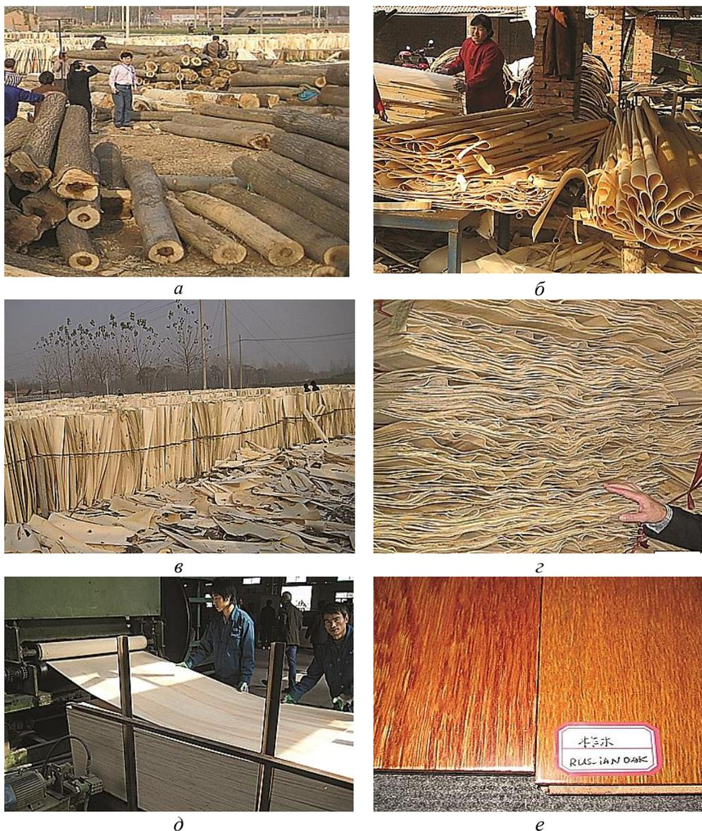
Рис. 2. Изготовление фанеры и мебельных плит из тополя: *a* – разгрузка тополевых бревен; *б* – получение шпона; *в* – сушка шпона; *г* – складирование шпона; *д* – изготовление фанеры; *е* – мебельные фанерные плиты из тополя, облицованные дубовым шпоном (КНР, ноябрь 2008; фото А.П. Царева)
