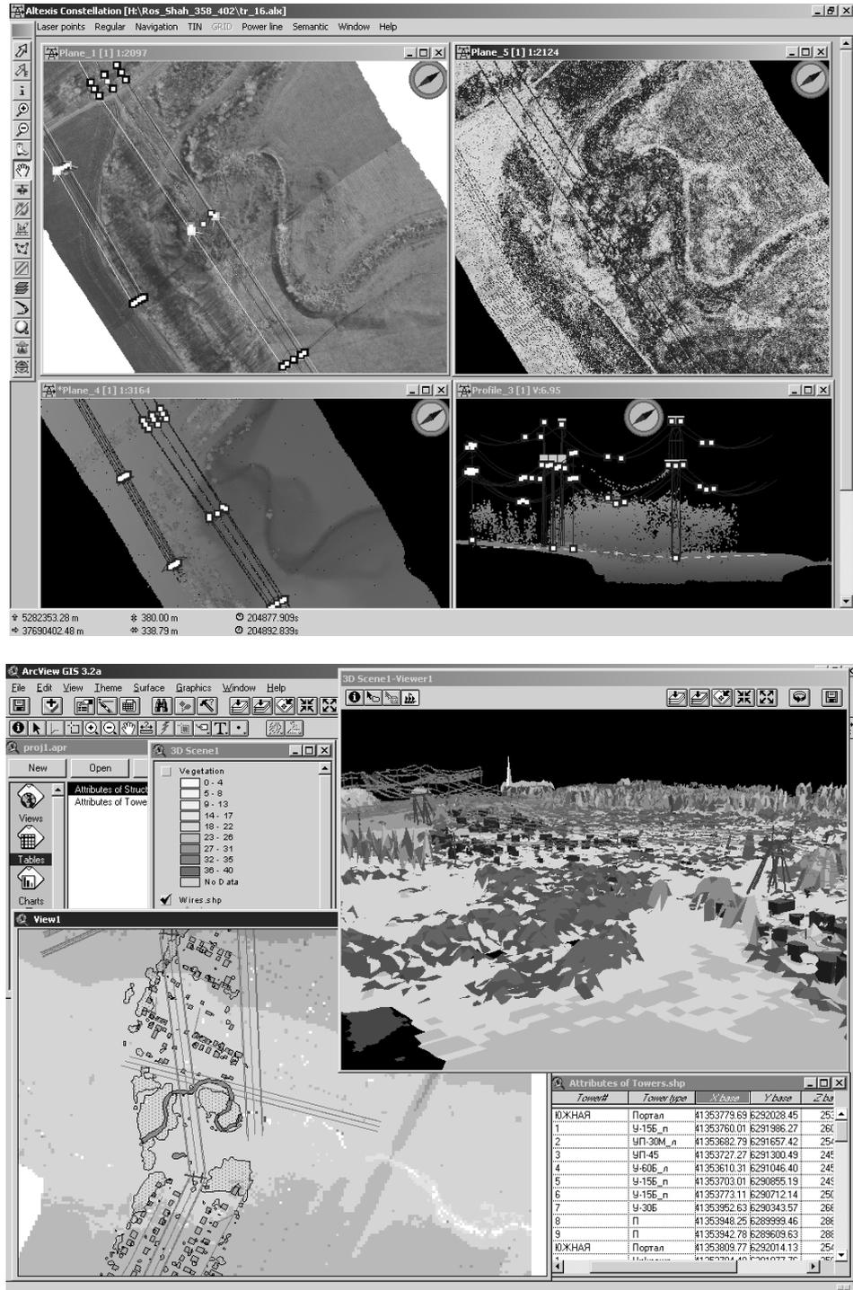
Рис. 2. Интегрированный анализ цифровых аэросъемочных, лазерно-локационных и радарных данных и их представление в ГИС-приложениях
