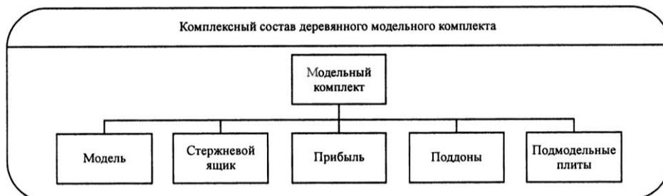
Рис. 1. Обобщенный состав модельного комплекта
