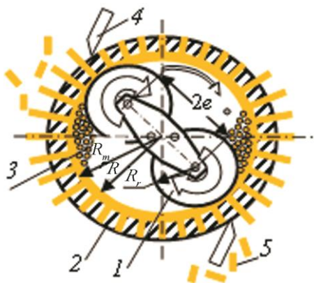
Рис. 1. Схема пресс-гранулятора с барабанной матрицей: 1 – прижимные ролики; 2 – перфорированная матрица; 3 – исходная масса из древесной коры; 4 – ножи; 5 – гранулы из древесной коры
