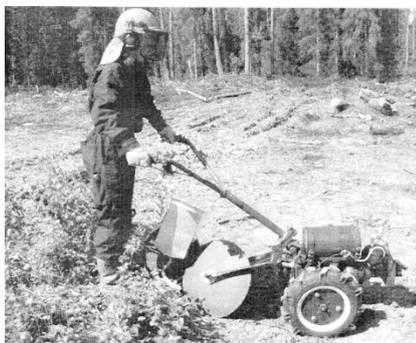
Рис. 2. Ресурсосберегающий малогабаритный посевной агрегат на базе мотоблока
