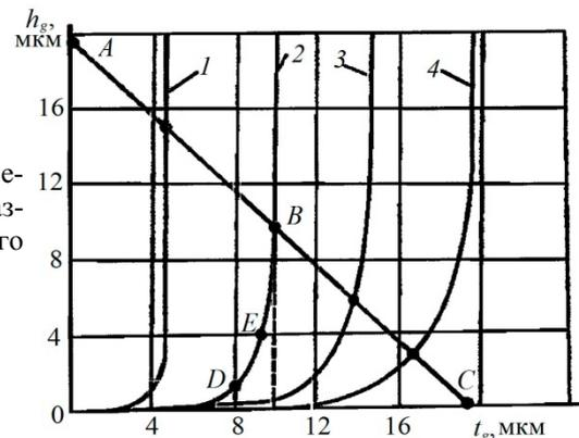
Соотношение между глубиной микрорезания и износом вершины зерна при различных значениях износа абразивного инструмента
