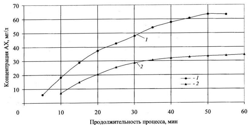
Рис. 1. Кинетические кривые восстановления образцов АХ (концентрация NaOH – 6,4 г/л, D -глюкозы – 1,7 г/л, температура 60 °С): 1 – АХФ; 2 – АХА
