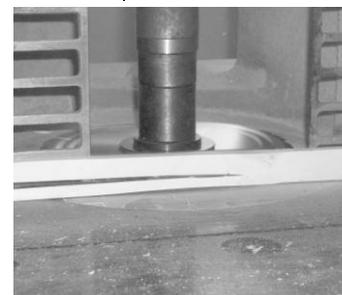
Рис. 2. Процесс разрезания заготовки осины на станке ФСШ-1А
