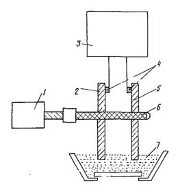
Устройство содержит электродвигатель 1, на вал 6 которого (изготовленного из диэлектрического материала) насажены два диска 2 и 5, выполненные из электропроводящего материала. Диски помещены в поток древесной стружки 7, находящейся на ленте транспортера. Электроды 4 контактируют с дисками и связаны с электро-
