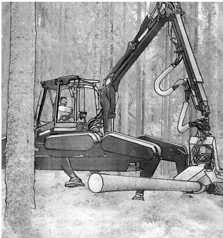
Рис. 1. Шагающий многооперационный аппарат фирмы TIMBERJACK (Канада)
