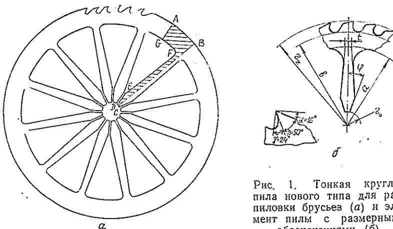
Рис. 1. Тонкая круглая пила нового типа для распиловки брусьев (а) и элемент пилы с размерными обозначениями (б)
