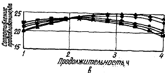
Рис. 5. Зависимость сопротивления продавливанию от факторов отбелики пероксидом водорода на ступени ЩП 2 : а – температура при различном расходе H_2O_2 , б – продолжительность при различном расходе H_2O_2 ; в – то же при различной температуре (см. обозначения на рис. 3)
