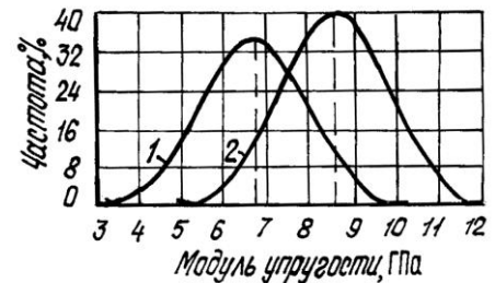
Рис. 2. Распределение модуля упругости пиломатериалов, выпиленных из срединных бревен диаметром 22 см (1) и комлевых диаметром 26...28 см (2)
