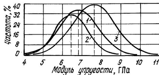
Рис. 1. Распределение модуля упругости пиломатериалов, выпиленных из бревен номинальным диаметром 22 см: 1 – модуль упругости отдельных сечений пиломатериалов; 2 – средний модуль упругости досок, выпиленных из некомлевых бревен; 3 – то же из комлевых
