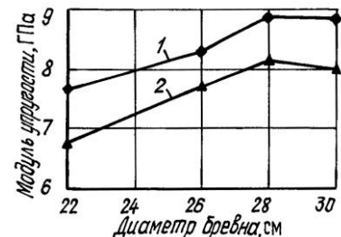
Рис. 3. Зависимость модуля упругости досок от диаметра комлевых бревен: 1 — средний, 2 — минимальный
