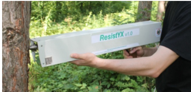
Рис. 3. Устройство для измерения сопротивления сверлению ResistYX
