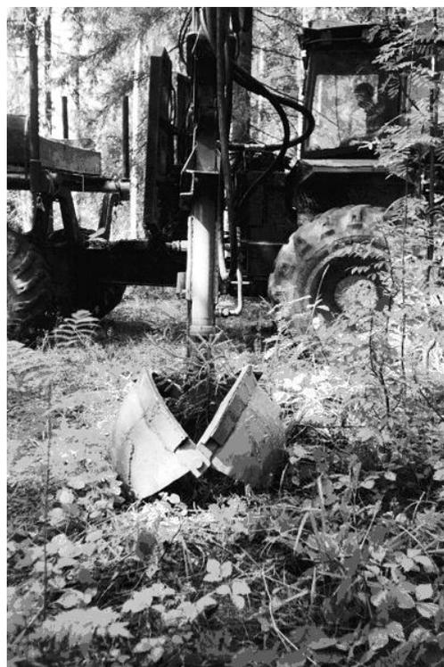
Рис. 2. Выкопка подроста устройством на базе форвардера «Валмет- 862»
