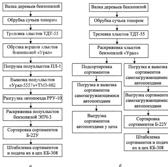
Существующий и проектируемые варианты технологического процесса (рис. *а*, *б*) сравнивали по эксплуатационным затратам, капитальным вложениям и приведенным затратам. Расчет выполняли для годового объема заготовки и вывозки лесоматериалов в виде хлыстов  $Q_{\text{год}} = 19,821$  тыс.м<sup>3</sup>.
