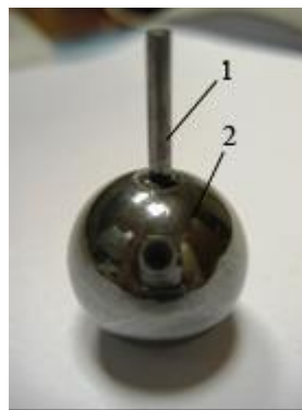
Рис. 3. Экспериментальный образец: 1 – направляющий стержень; 2 – шарик
