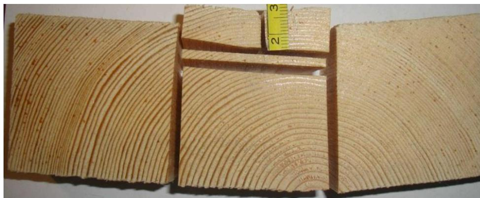
Рис. 6. Глубина распространения микротрещины в лиственничной доске при сушке в свободном состоянии
