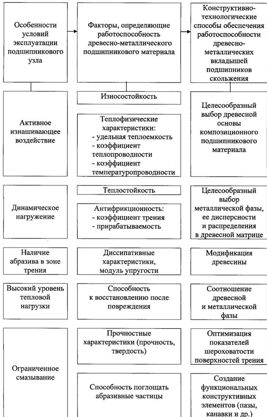
Система взаимосвязи эксплуатационных особенностей подшипников скольжения, факторов, обеспечивающих управление уровнем работоспособности, и возможных путей ее оптимизации
