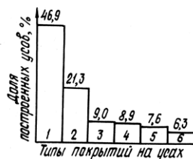
Рис. 1. Доля протяженности усов по типам покрытий: 1 – зимние; 2 – УЖД; 3 – деревянно-лежневые; 4 – грунтовые; 5 – на хворостяной подушке; 6 – с инвентарным покрытием
