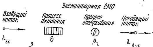
Рис. 1. Элементарная СМО:  $\lambda_{вх}$  — интенсивность входящего потока;  $\mu_i$  — интенсивность обслуживания в системе;  $\theta$  — длина очереди на обслуживание;  $\lambda_{вых}$  — интенсивность выходного потока
