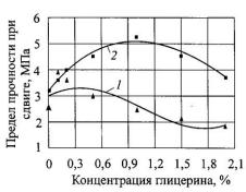
нах и выдерживали под давлением 5 кг/см<sup>2</sup> в течение суток, затем их освобождали от зажимов и выдерживали при комнатной температуре еще трое суток. Горячее склеивание образцов проводили в прессе для пластических масс марки Д 2430Б с размерами плит 350×390 мм ( $t=130\,^{\circ}$ C,  $P=5\,$  кг/см<sup>3</sup>,  $\tau=10\,$  мин) После чего вырезали стандартные образцы для испытания предела прочности при сдвиге.
