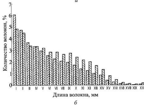
Рис. 4. Распределение по длине волокон технической целлюлозы из древесины сосны (см. обозначения на рис. 3)
