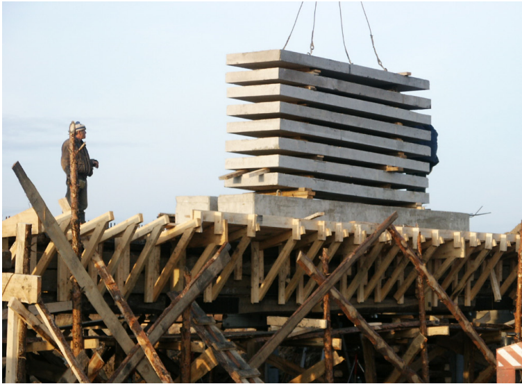
Рис. 17. Испытание спаренного составного прогона статической нагрузкой (в пролете)
