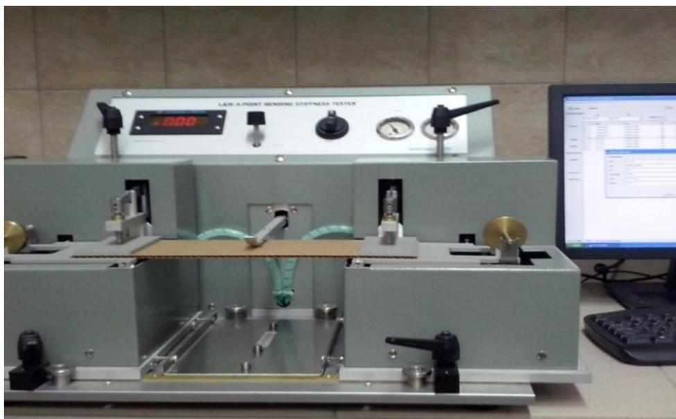
Рис. 1. Внешний вид прибора L&W 4-point Bending Stiffness Tester SE 108 для определения жесткости при изгибе по 4-точечному методу
