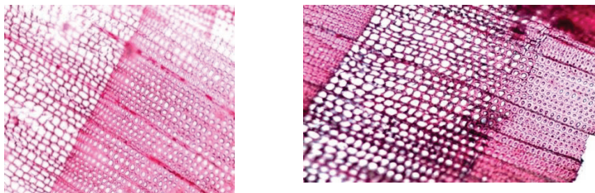
Поперечные срезы древесины толщиной 30 мкм, приготовленные на роторном замораживающем микротоме
