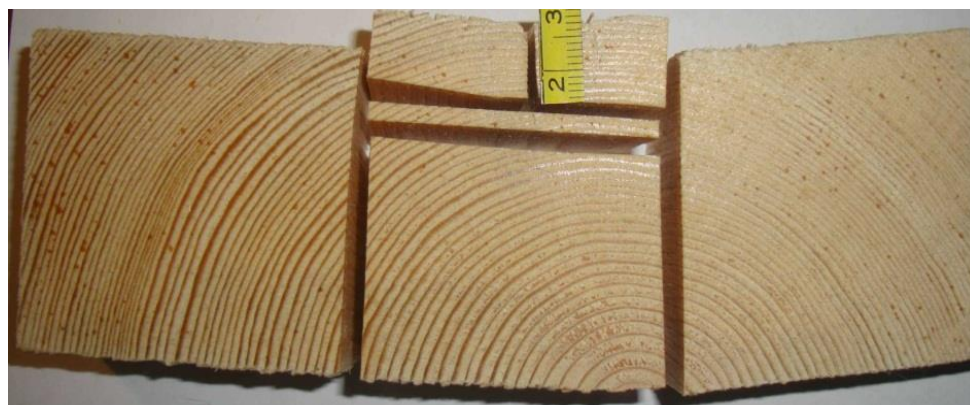
Рис. 6. Глубина распространения микротрещины в лиственничной доске при сушке в свободном состоянии
