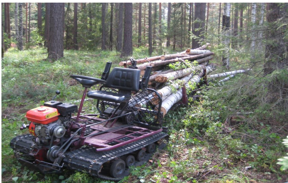
Рис. 1. Лабораторный образец мини-трактора МТР-1
