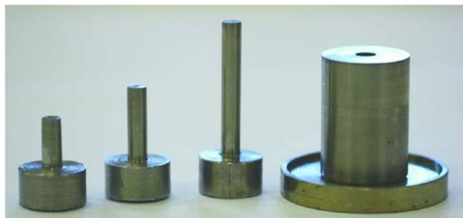
Рис. 1. Плунжеры и пресс-форма для прессования гранул из термомодифицированной древесной коры
