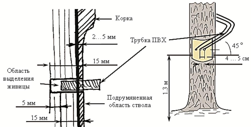
Рис. 1. Схема установки трубок ПВХ для оценки смолопродуктивности
