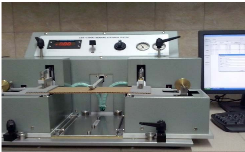
Рис. 1. Внешний вид прибора L&W 4-point Bending Stiffness Tester SE 108 для определения жесткости при изгибе по 4-точечному методу
