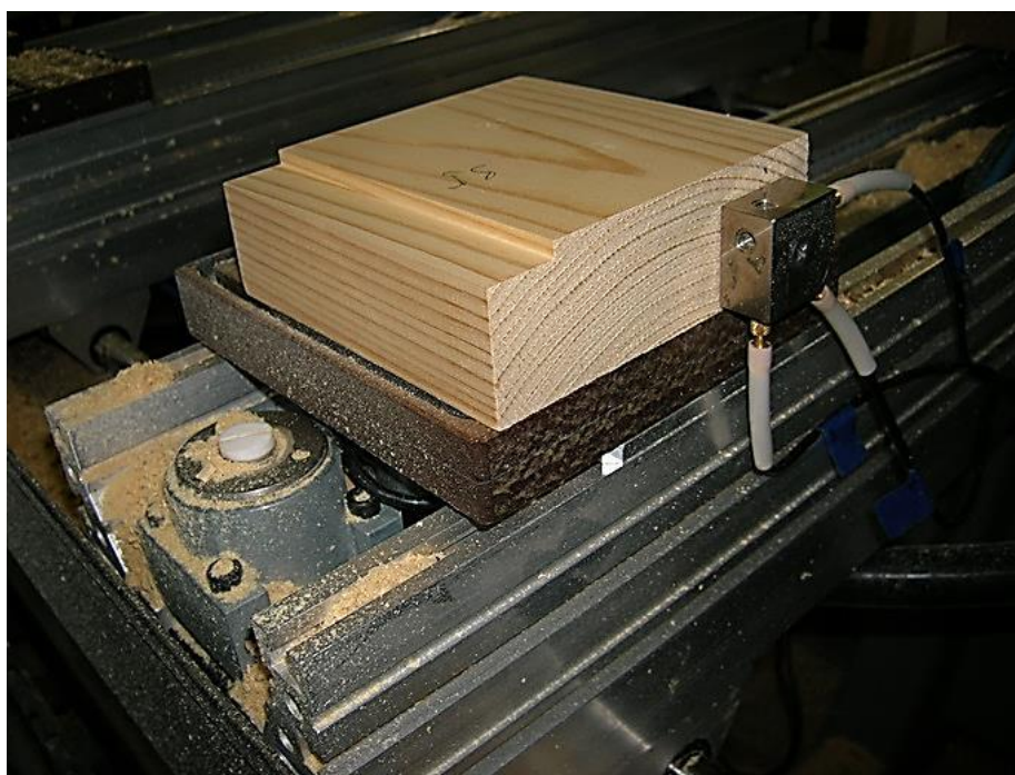
Рис. 2. Схема установки датчика на заготовке
