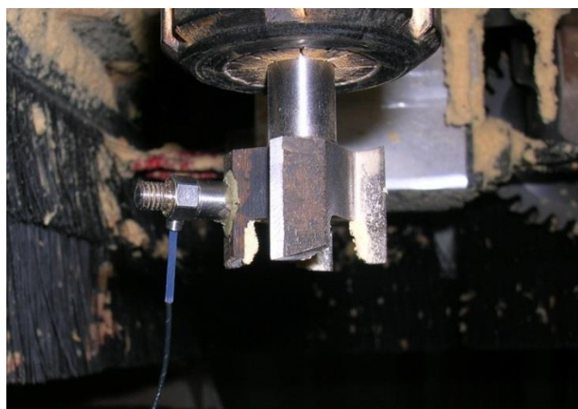
Рис. 4. Схема установки датчика на фрезе
