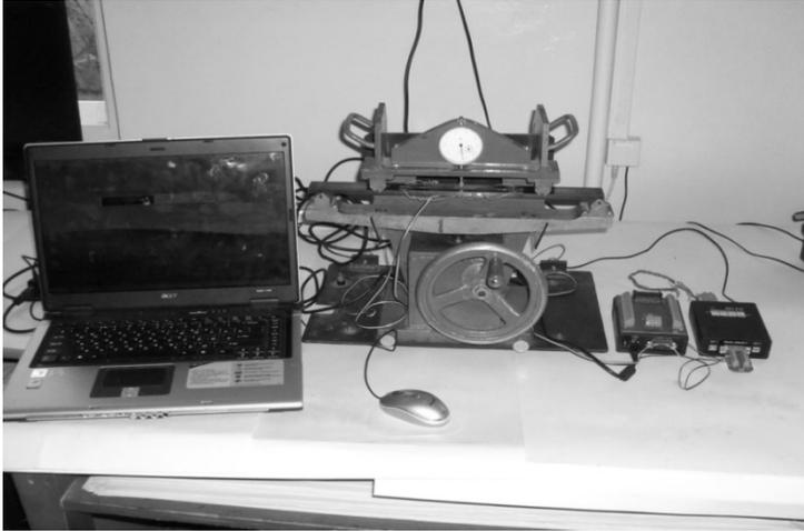
Рис. 2. Измерительный комплекс для тарировки тензодатчиков
