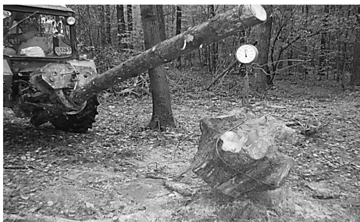
Рис. 3. Определение массы центральной части корневой системы
